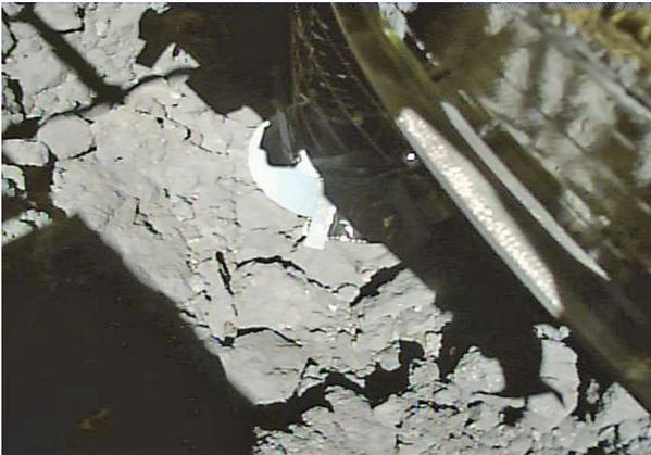
**Abb. 7 Aufnahme während der zweiten Landung am 11. Juli. Rechts im Bild ist ein Teil des runden Sammelgerätes erkennbar (Foto: JAXA).**
